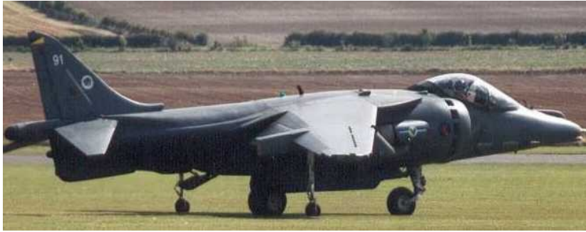
Monotrace avec balancines: Harrier Gr7
