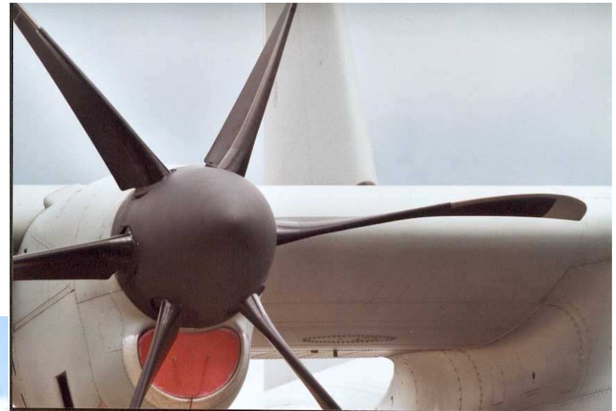
Hélice à 6 pales en fibre de carbone
