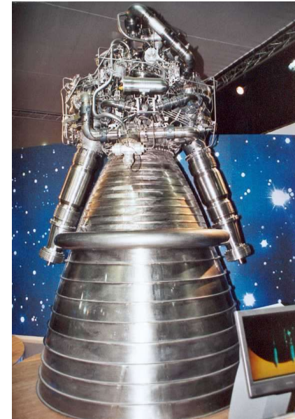
Vulcain. Moteur cryogénique principal d'Ariane V 135 Tonnes de poussée
