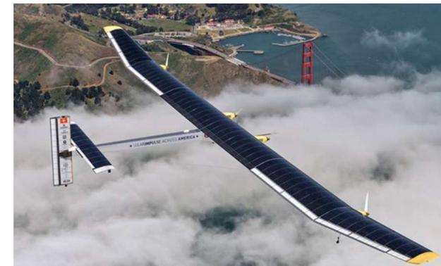
Solar Impulse (envergure 72 m, 2300 kg, 1 passager, 17248 cellules photovoltaïques, 62 km/h)
