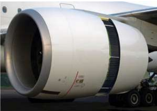
Inverseur à grilles: Boeing 747
