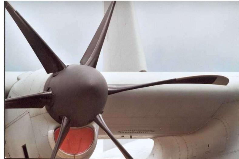
**hélice à 6 pales en fibre de carbone**
