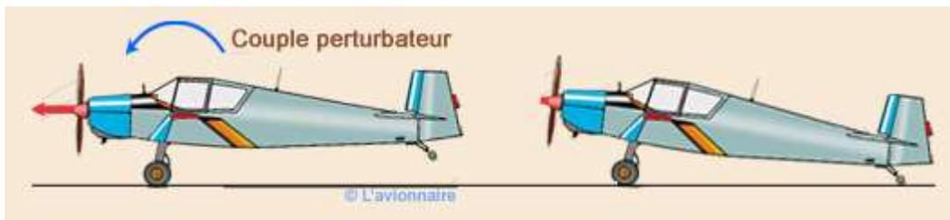
Un exemple de perturbation autour de l'axe de tangage : avion train classique au décollage . Quand on soulève la roulette arrière, rotation autour de l'axe de tangage → l'avion embarque à gauche. Compensé par « du pied à droite » !
