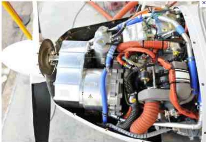
**1) Un système de propulsion hybride. A gauche, on distingue le moteur électrique et son réducteur entraînant l'hélice. A droite, on voit le petit moteur thermique Wankel. (crédit Siemens)**
