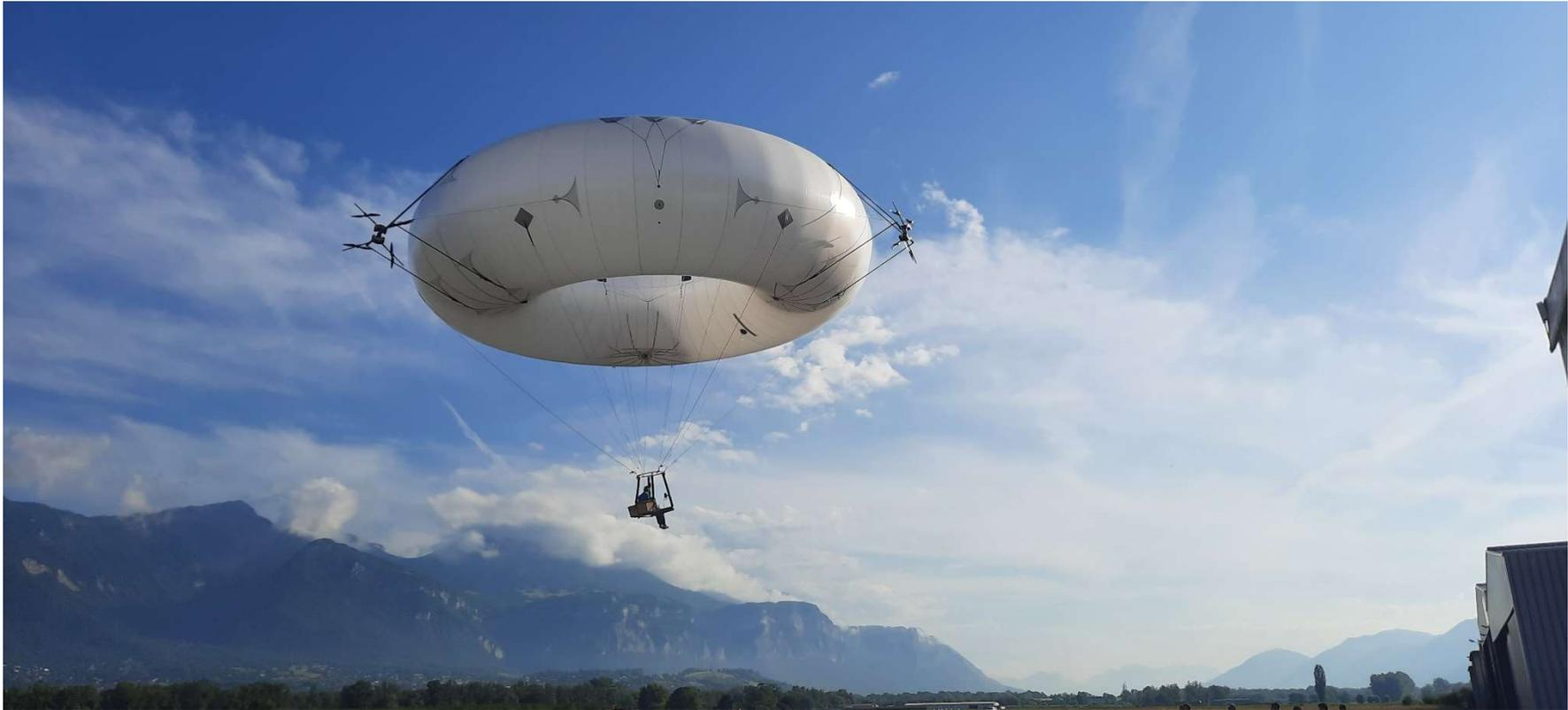
L'aérOnde est **un aéronef à motorisation 100% électrique**, sustenté grâce à l'hélium, à décollage et atterrissage vertical (eVTOL), permettant de voler avec **2 personnes à bord** et de la charge, en silence, avec très peu d'énergie, pendant plusieurs heures.
