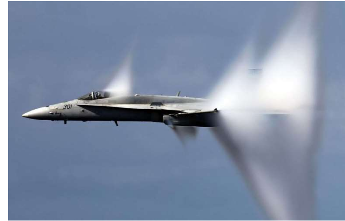
Onde de choc visualisée par la condensation dans de l'air très humide
