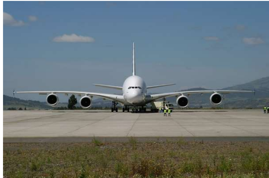
Aile basse, dièdre à l'emplanture Airbus A380 (Europe, 2005)
