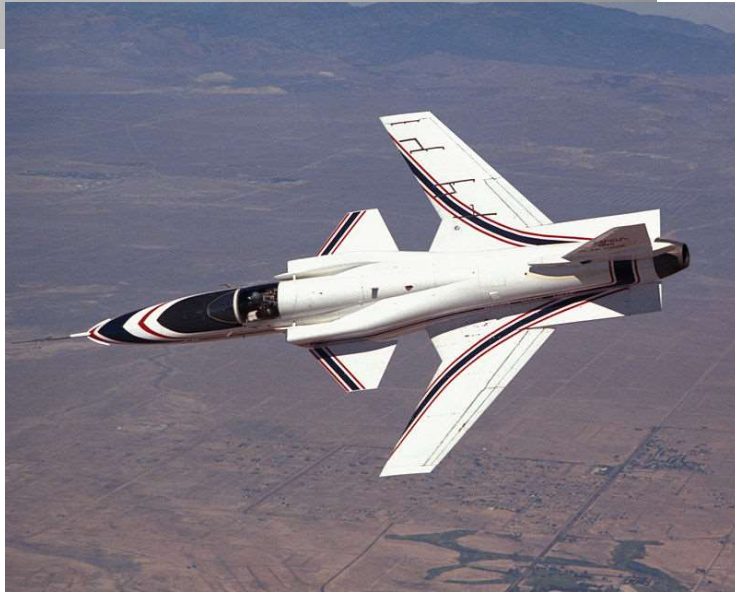
voilure canard avec aile à flèche inverse du Grumman X29 (USA, 1984)
