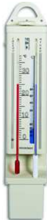
un psychromètre (combinaison d'un thermomètre mouillé et d'un thermomètre sec)
