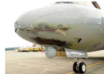
Dans la cabine, le foudroiement s'accompagne souvent d'un grand éclair et d'un coup de tonnerre. Les passagers ne risquent rien car les charges électriques passent par la peau extérieure de l'avion (cage de Faraday). Les cellules des avions classiques (non-composite) ont une structure métallique avec une épaisseur suffisante pour résister à un foudroiement. Au sol le personnel connecté à l'avion par le biais d'un casque filaire peut être foudroyé.
